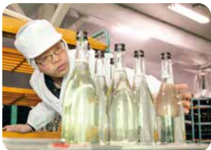
一本一本厳重に瓶詰め後の検品作業を行う
